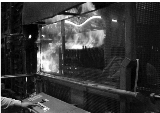
Ved stærk varmepåvirkning hærdes forskellige mekaniske metaldele. I afdelingen oplæres medarbejderne til dette arbejde.
